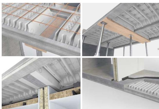
Étapes de réalisation d'une bande noyée pour la mise en œuvre de cloison légères séparatives (source : KP1)
