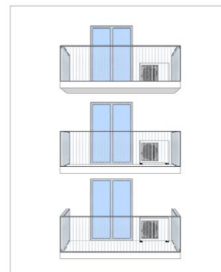
Balcons décloisonnés Garde-corps ajourés
